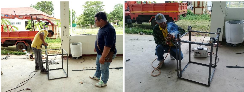
ภาพการประกอบโครงเครื่องปั่นแห้งดอกดาวเรือง
